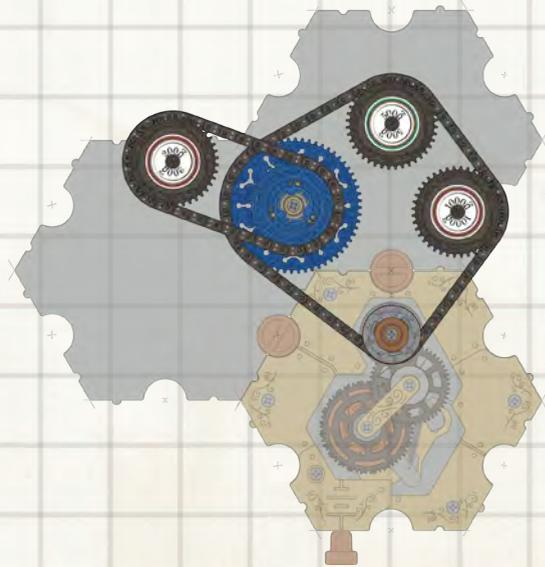
Jetzt halte das obere Kettenrad des Knotenpunkts mit deinen Fingern, während du den Schaltkreis laufen lässt. Denk daran, dass sich der Knotenpunkt wie eine Reihenschaltung verhält, sobald du eines seiner Kettenräder festhältst! Der gesamte Strom fließt über ein Kettenrad hinein und über ein anderes hinaus.
