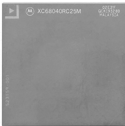
Foto eines Motorola 68040-Prozessors, aufgenommen von Konstantin Lanzet. Geteilt unter CC BY-SA 3.0-Lizenz unter https://en.wikipedia.org/wiki/Motorola_68040 .
